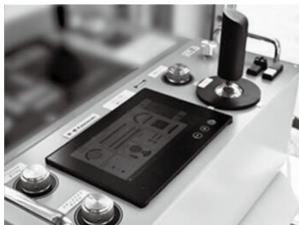
「安全離着岸支援システム」の操船支援制御装置 (出典：川崎重工プレスリリース)
