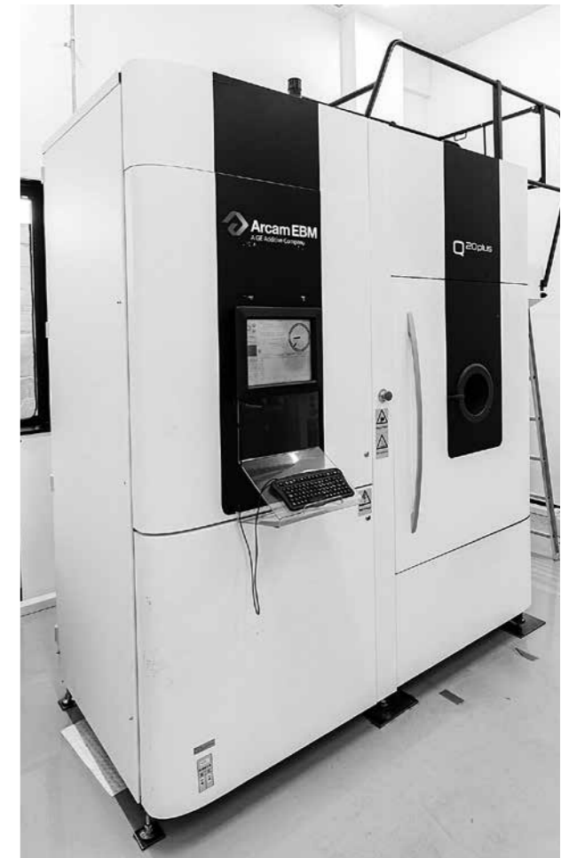
JAMPTが所有する電子ビーム方式の3D金属プリンター「Arcam Q20+」
