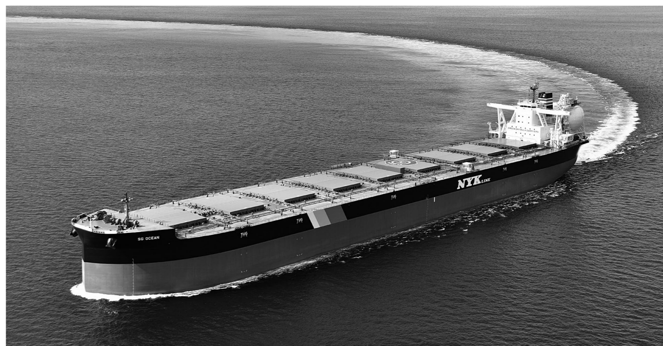
今年1月竣工のLNG燃料ケープサイズバルカー「SG OCEAN」
