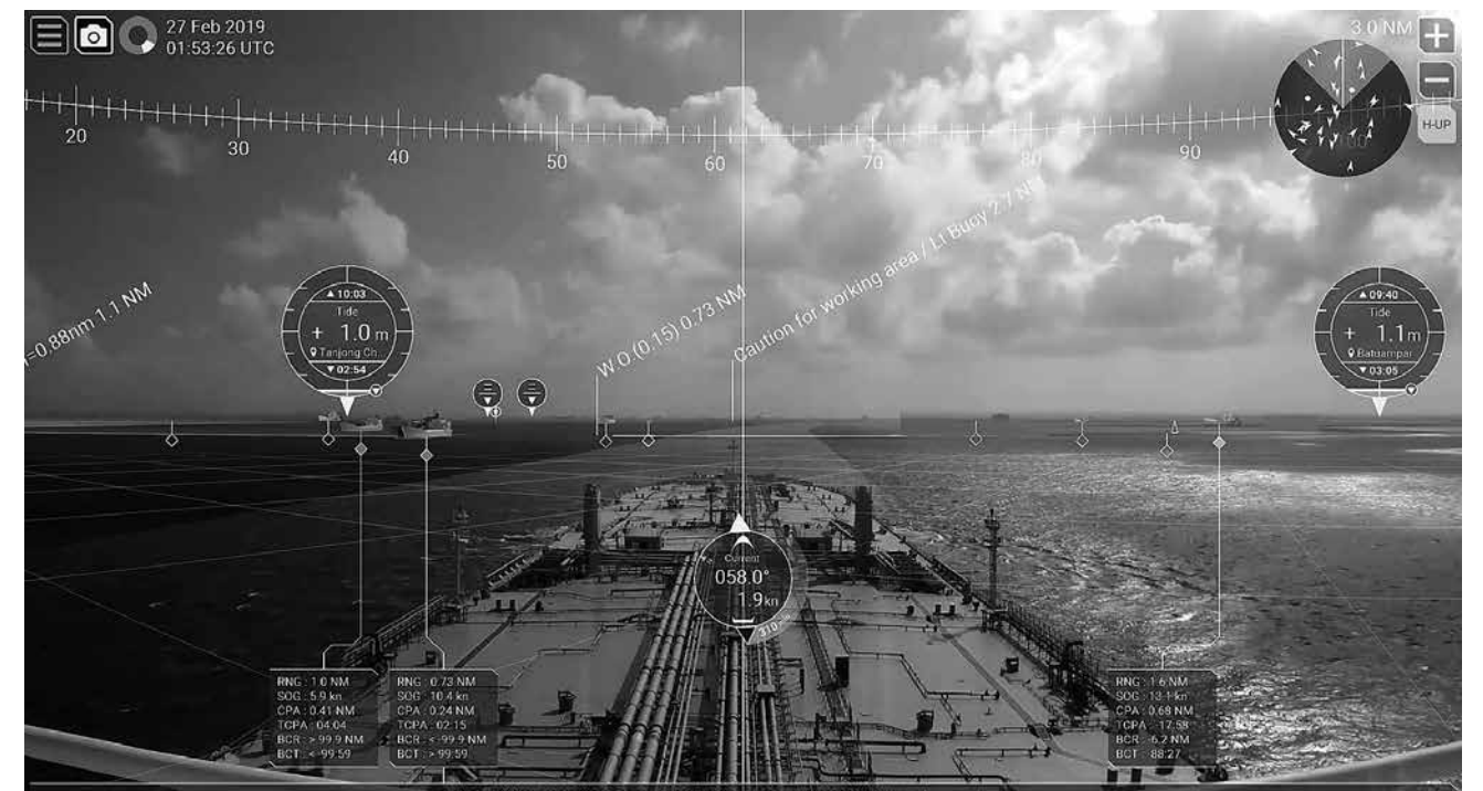
航行に必要な情報をカメラの映像上に重ねて表示する「ARナビゲーションシステム」
