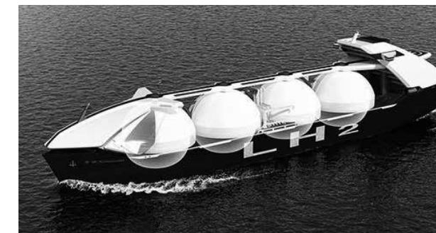
4万m 3 タンクを4基搭載した大型液化水素運搬船のイメージ
