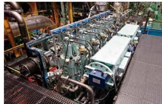
ガスエンジン「G30」。燃焼室部以外は従来機関と同じ構造で、信頼性・耐久性を引き継いで
