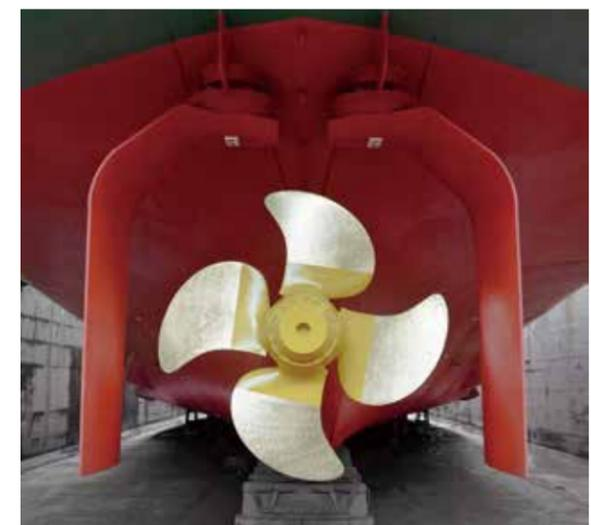
ゲートラダーシステムを搭載した「しげのぶ」。プロペラの両脇に舵板がある。
