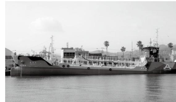
旭タンカーが発注し、井村造船で建造中だったピュアバッテリー電気推進(EV)タンカー「あかり」(写真)が3月28日に竣工した。今後は陸上給電設備による受電試験などを経て、2022年3月に竣工したEVタンカー「あさひ」とともに、東京湾内で船舶燃料補給業務に従事する予定だ。
