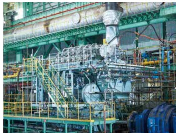
MGO専焼のため燃料系統がシンプルに、また入港時の燃料切り替え作業も不要になる
