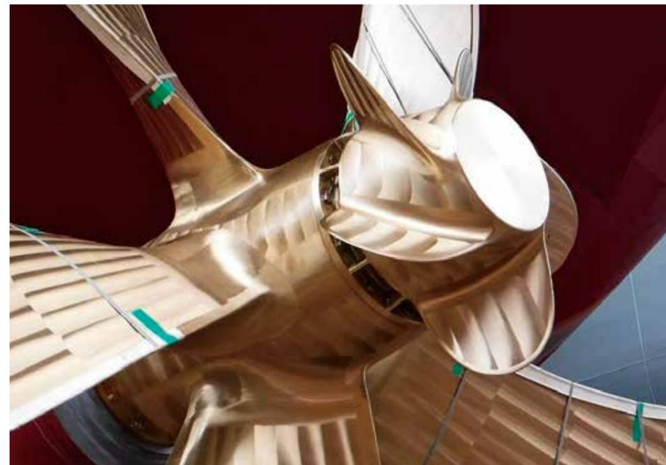
プロペラの先端に取り付けるPBCF。小さな翼があり、ハブ渦を解消して燃費効率の改善につなげる
