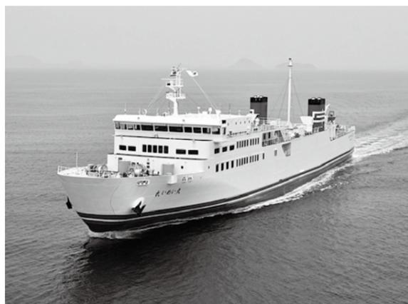
「れいめい丸」は、球状船首と双胴型船尾を採用し、推進性能と耐航性の向上を図っている。また、航海中の横揺れを軽減するため、船体中央部にフィンスタビライザを備えている。この他、昇降設備として右舷側にエレベーターを装備し、バリアフリー設備として車両甲板から第一遊歩甲板への移動が可能となっている。
