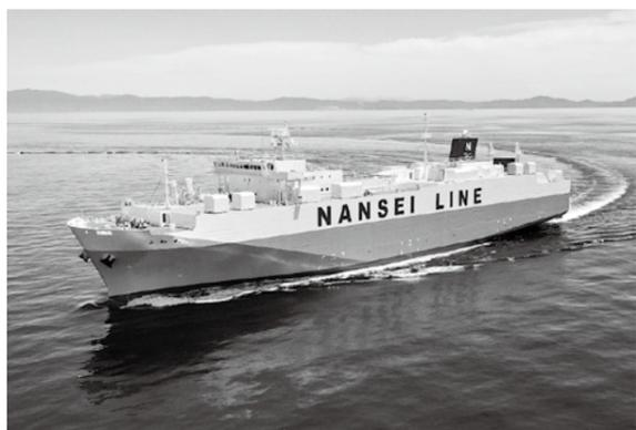
「よね丸」の貨物艙はシャーシ・乗用車・コンテナ倉が2層、シャーシ・乗用車倉が1層、乗用車倉が1倉の計4層で構成されている。電子制御型主機関(ME-B型)を採用し、燃費低減と低負荷での燃焼状態の改善を図った。また、航海中の横揺れを低減するフィンスタビライザや船首・船尾にスラストを装備し、離接岸性能を向上した。
