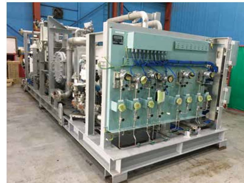
LNG燃料ガス供給システム、FGSSのモジュール
