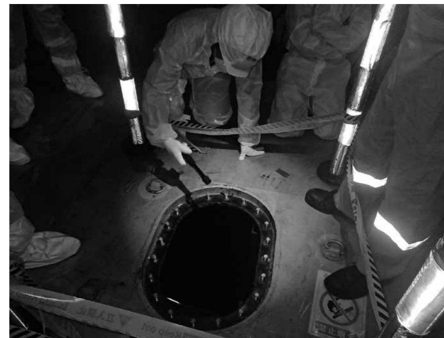
自社船の燃料タンク内の汚れをチェックしている様子
