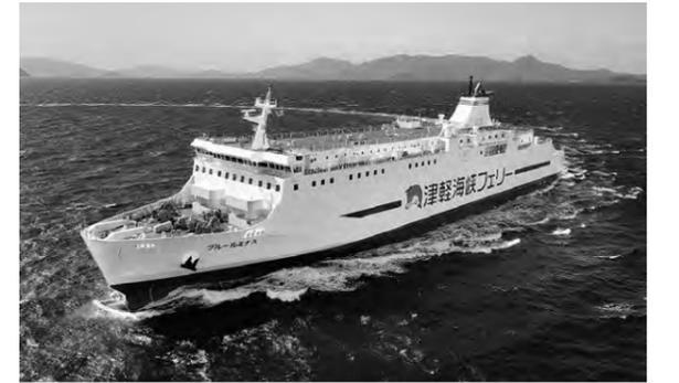
「ブルールミナス」は「ブルードルフィン2」の代替船で、内海造船・瀬戸田工場が建造した。船型に球状船首と単胴型普通船尾を採用し、推進性能と耐航性の向上を図ったほか、船体中央部に備えたフィンスタビライザーで航海中の横揺れを軽減するなどしている。また、有事の際に被災地に支援物資などを緊急輸送できる「災害時多目的船」となっている。
