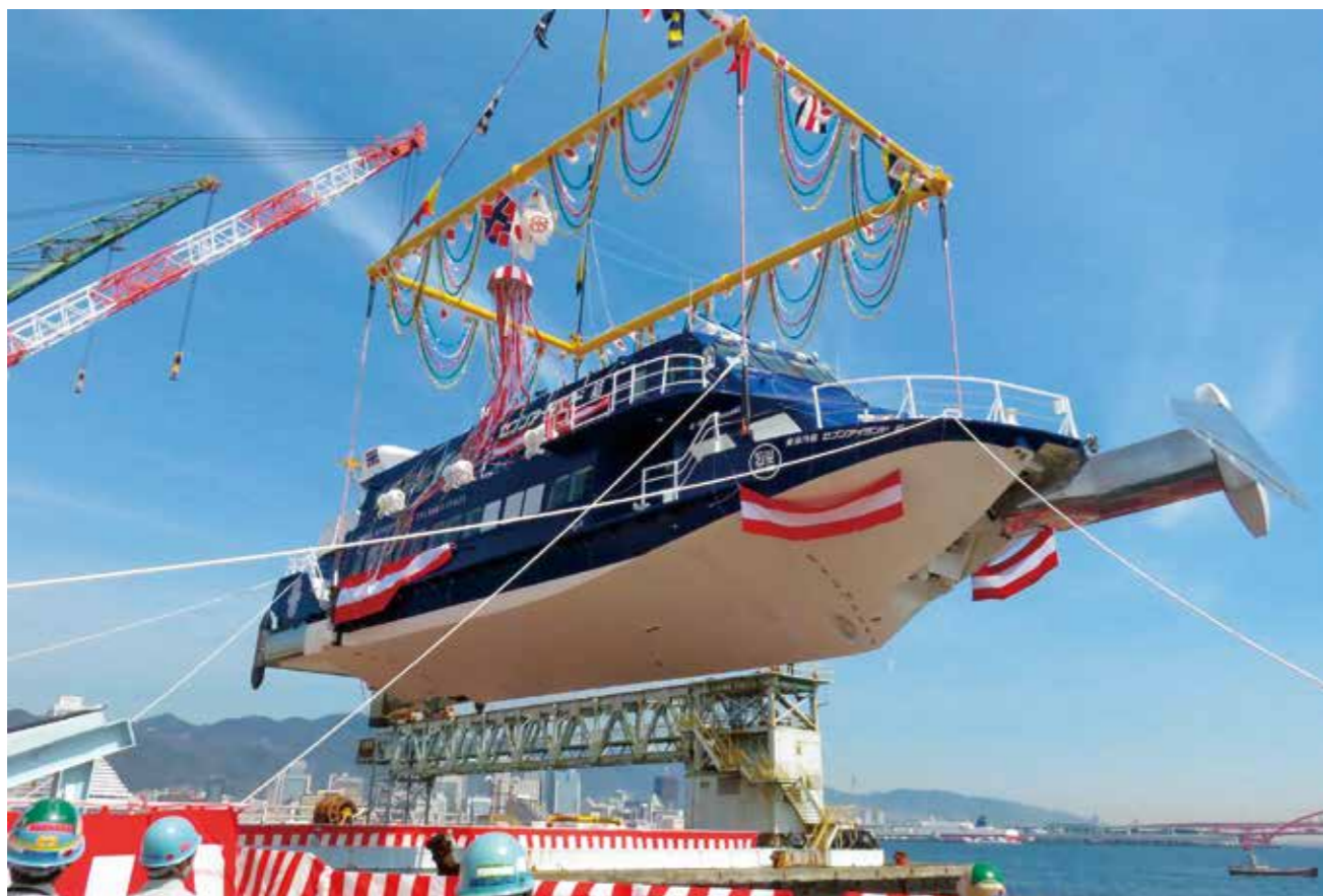
「セブンアイランド結」主要目 全長：27.4m、型幅：8.5m、速力：43ノット、旅客定員：241名
